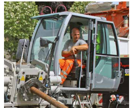
Поворотная кабина управления на 90° вкл. систему отопления и кондиционирования
