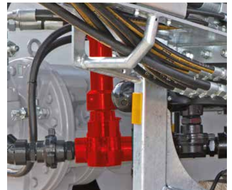
Механизм подачи бурового раствора, гидравлическое перекрытие с байпасом
