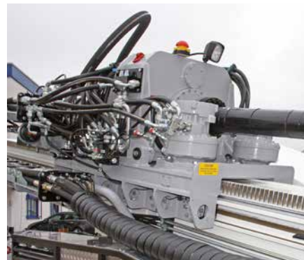
Прочный верхний силовой привод с крутящим моментом 18 кНм - 45 кНм
