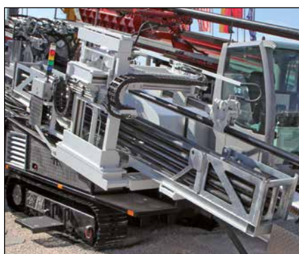
Полностью автоматический накопитель для 12 бурильных труб
