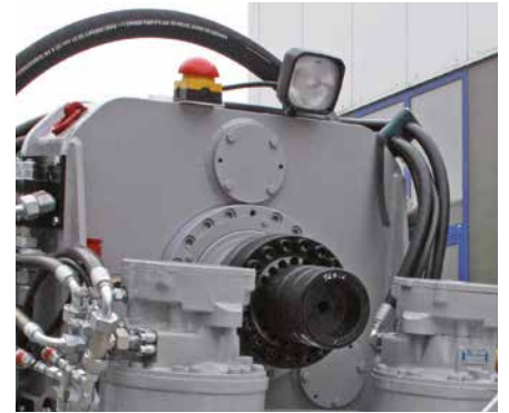
Камера и прожектор для верхнего силового привода и зажимного устройства
