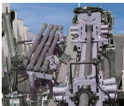
Полуавтоматический механизм подачи для 5 бурильных труб
