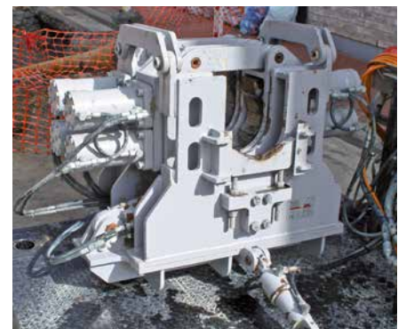
Устройство для развинчивания бурильных труб с регулируемым углом выхода 6° - 22°
