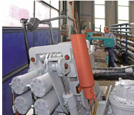
Система автоматической смазки бурильных труб
