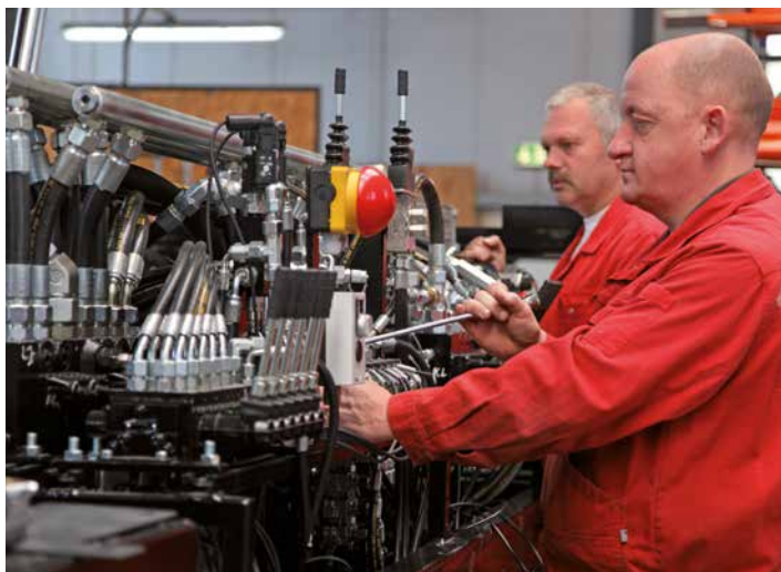
Сборка гидравлики блока управления
