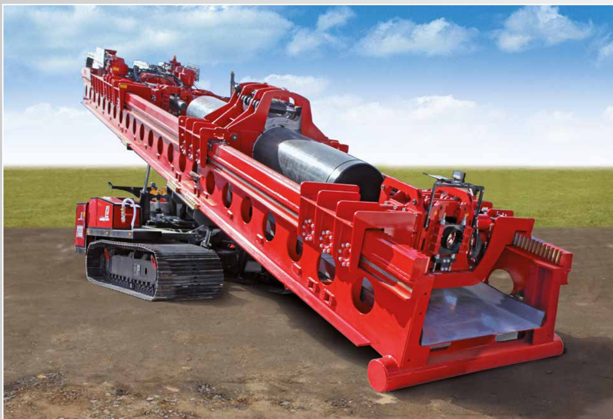
Установка ГНБ со встроенной системой продавливания труб
