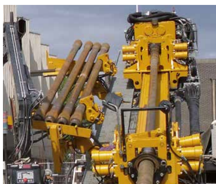
Полуавтоматический механизм подачи для 5 бурильных труб
