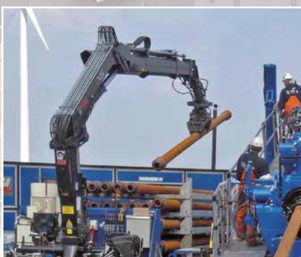
Кран для поднятия бурильных труб с пультом дистанционного управления
