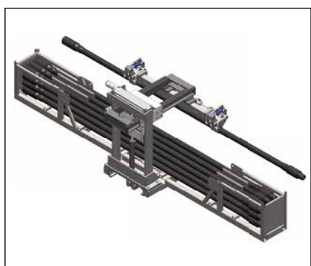
Полностью автоматический накопитель для 72 м бурильных труб
