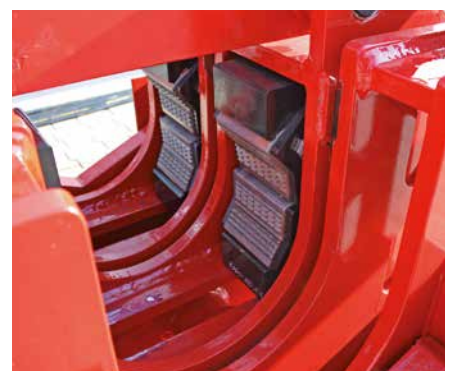
Зажимное устройство со сменными и самоцентрирующимися зажимными кулачками
