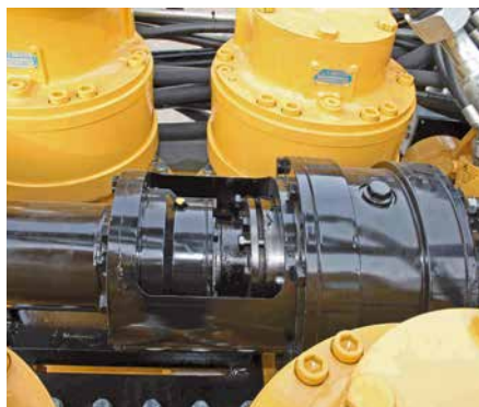
Конический роликовый подшипник вертлюга для бурения с промывкой буровым раствором
