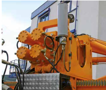
Система автоматической смазки бурильных труб
