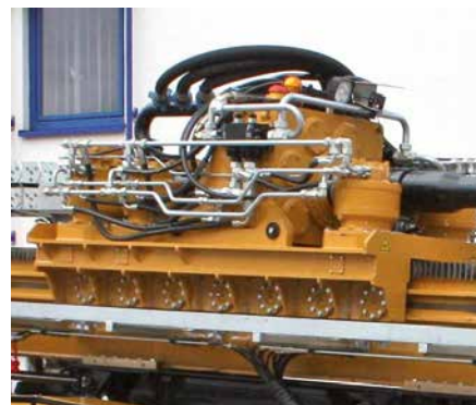
Прочный верхний силовой привод с крутящим моментом 18 кНм - 64 кНм
