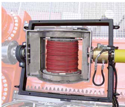
Катушка кабеля с гидромотором и электрическим управлением направления вращения
