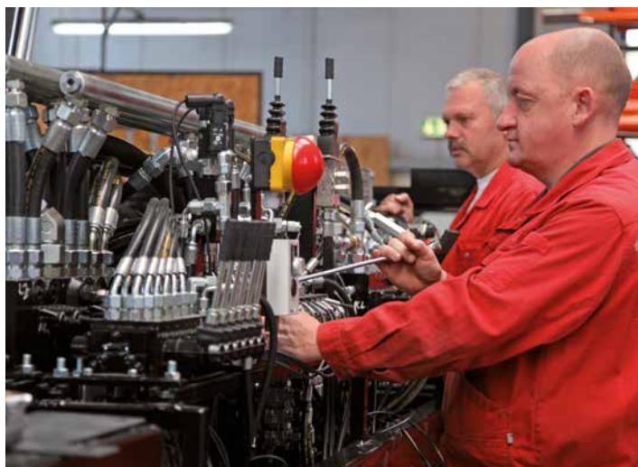
Сборка гидравлики блока управления
