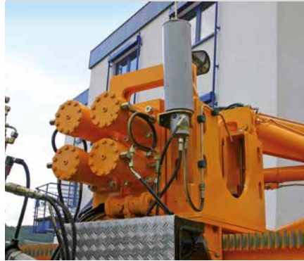
Система автоматической смазки бурильных труб
