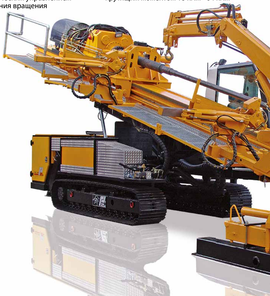
Прочный верхний силовой привод с крутящим моментом 18 кНм - 64 кНм
